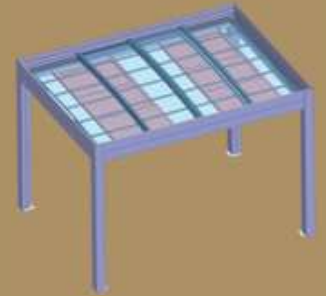
Toiture fermée, brise-soleil dépliés
