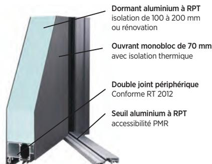
Dormant aluminium à RPT isolation de 100 à 200 mm ou rénovation
