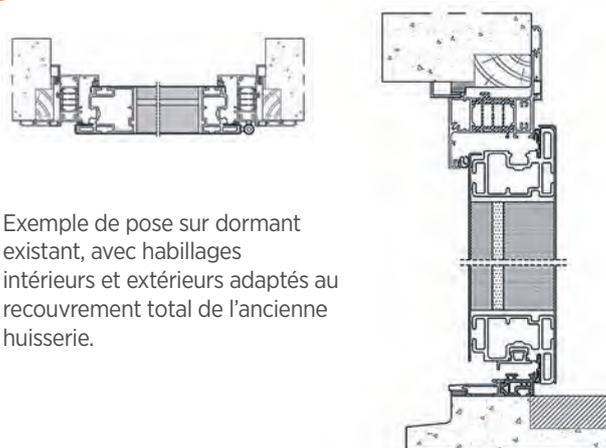
Exemple de pose sur dormant existant, avec habillages intérieurs et extérieurs adaptés au recouvrement total de l'ancienne huisserie.
