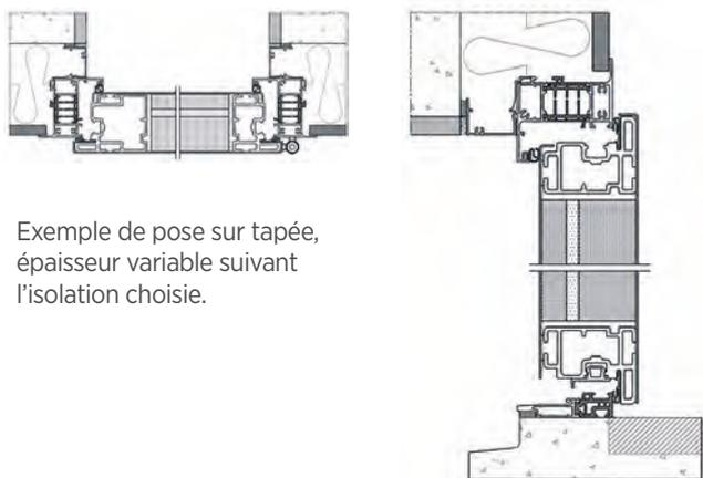
Exemple de pose sur tapée, épaisseur variable suivant l'isolation choisie.
